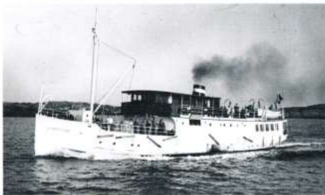
ALBREKTSUND i motoriserat och ombyggt skick på Hjärteröfjärden utanför Tjörn den 29 juli 1959. Matsalen på däck är borta och akterdäcket har byggts in. Den korta skorstenen är svart med ett brett vitt bälte. Foto Dag Almén
